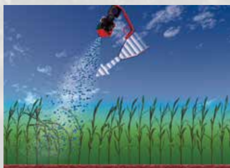
Naklonění systému dopředu pod úhlem 40°
